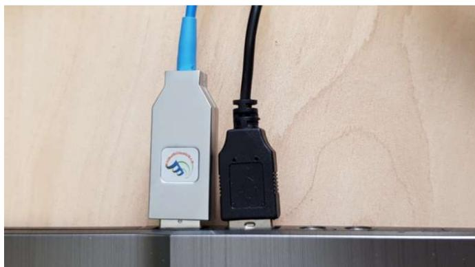
Abbildung 3: Einstecken des USB-Steckers am Laptop (USB 3)
