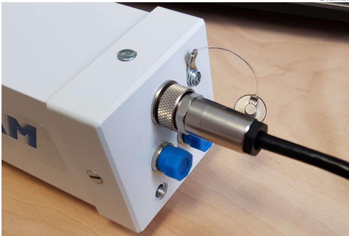
Abbildung 5: Ladeanschluss der IR-Thermografie-Kamera
